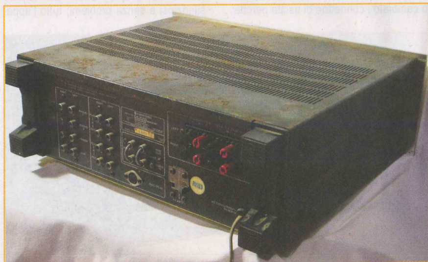
Foto 03 - Il retro come si presentava all'arrivo. La morsetteria è ancora quella originale, con un morsetto storto, un altro spanato. Il pannello è abbastanza in ordine ma il coperchio è un po' deformato -si vede che è rimasto a lungo con della roba pesante accatastata sopra- e molto rovinato da estese fioriture di ruggine. Uno dei selettori a slitta dei cambiatensione (ogni trasformatore ha il suo, cosa non molto razionale ma che probabilmente facilitava la costruzione) è rotto e bisogna cambiarlo.
