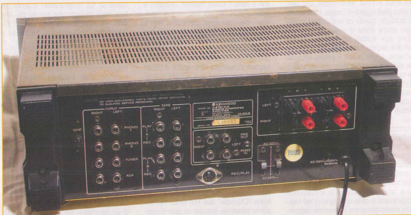
Foto 06 - Qui il retro, ripulito, coi morsetti d'ingresso lucidati e quelli di uscita sostituiti montando i nuovi sull'isolatore originale. Cambiati anche il cavo di rete e la slitta rotta che si vedeva in foto 02.
